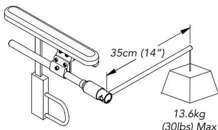
La tige de rotation Tri-Lock peut être montée à droite et à gauche. La faire pivoter dans la patte de montage pour vérifier que ses positions de rotation sont correctes.
