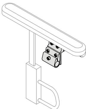
Les pattes de montage du joystick peuvent être installées sur l'accoudoir droit ou gauche. Fixer la patte sur le l'accoudoir, la pousser aussi loin que possible et serrer.
