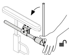
Appuyer sur l'extrémité pour déverrouiller
